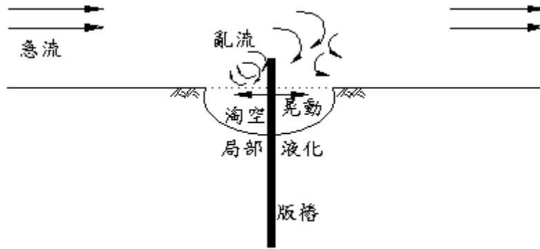
圖 10 洪流作用下版樁兩側淘空與沖刷現象
